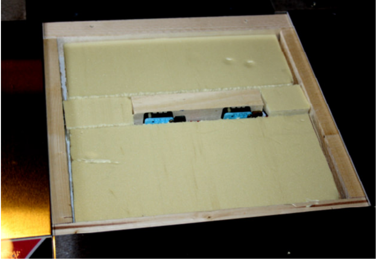
Sur notre photo l'épaisseur a été ajustée par un revêtement mural genre bull gomme.
